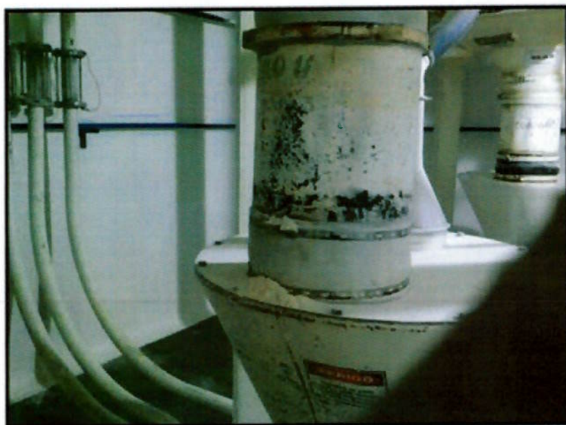
Figura 14. Etiquetas de não-conformidade. Farinheira com vazamento de farinha
