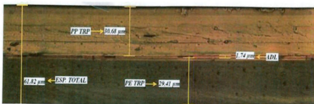
Figura 18. Etiqueta de não-conformidade: microscopia do filme BOPP
