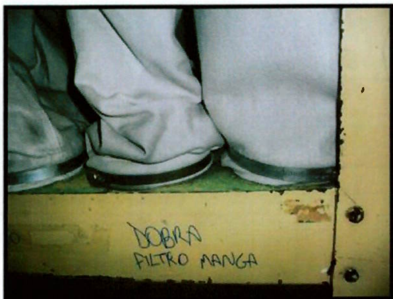
Figura 15. Etiquetas de não-conformidade: dobras do filtro manga servindo de abrigo ao gorgulho
